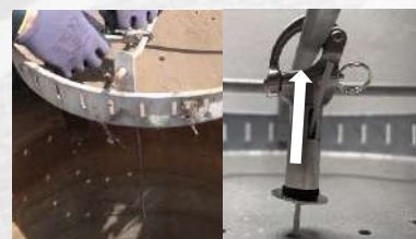
6. Schmutzfänger wieder einsetzen und Seil von unten in das Seilschloss einfädeln. Zum Entriegeln der Seildurchführung Druck auf die untere Scheibe ausüben.
